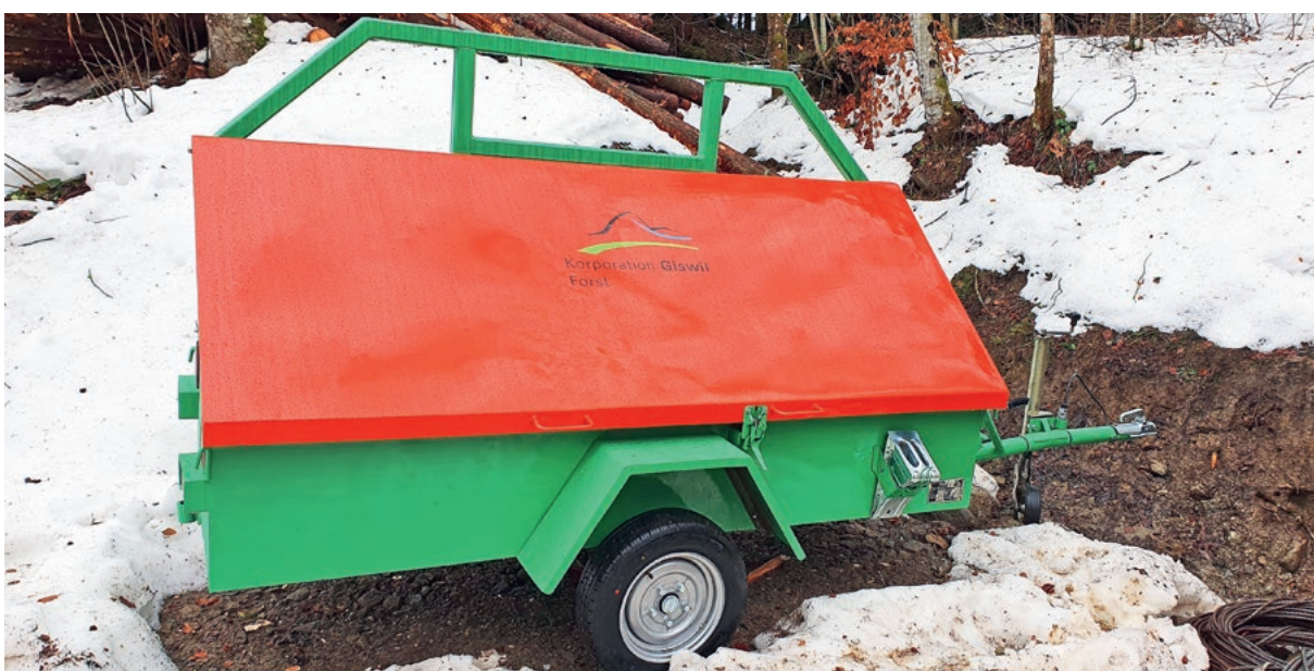
Durch Richi Bacher revidierter Werkzeuganhänger, mit montiertem Hebebügel zum Anheben mit Holzgange/Prozessor
