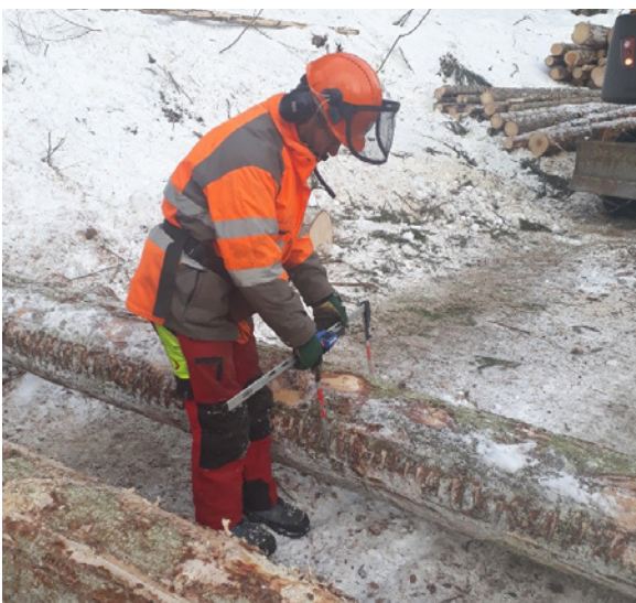
Einmessen der Saghölzer mit elektronischer Kluppe (Messinstrument) durch Peter Berchtold
