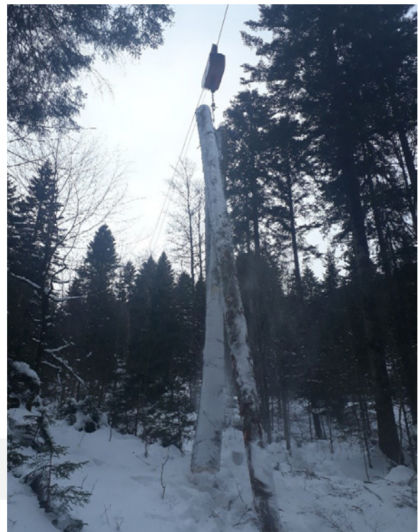
Holzbringung im Holzschlag mit dem Mobilseilkran K507
